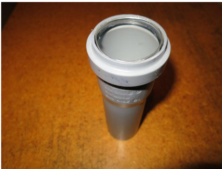
Abb. 4: Teleskop aus Polycalrohr mit einer Achromatischen Linse als Objektiv.
