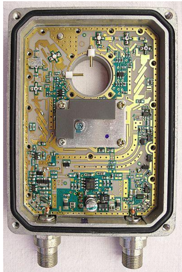
Fig.4: „Innenansicht“ eines LNB, Quelle: wikimedia
