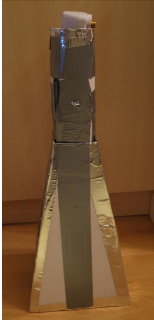
Fig.6: Hornantenne, Selbstbau aus Pappe und Aluminiumfolie. Oben auf der Antenne der LNB.
