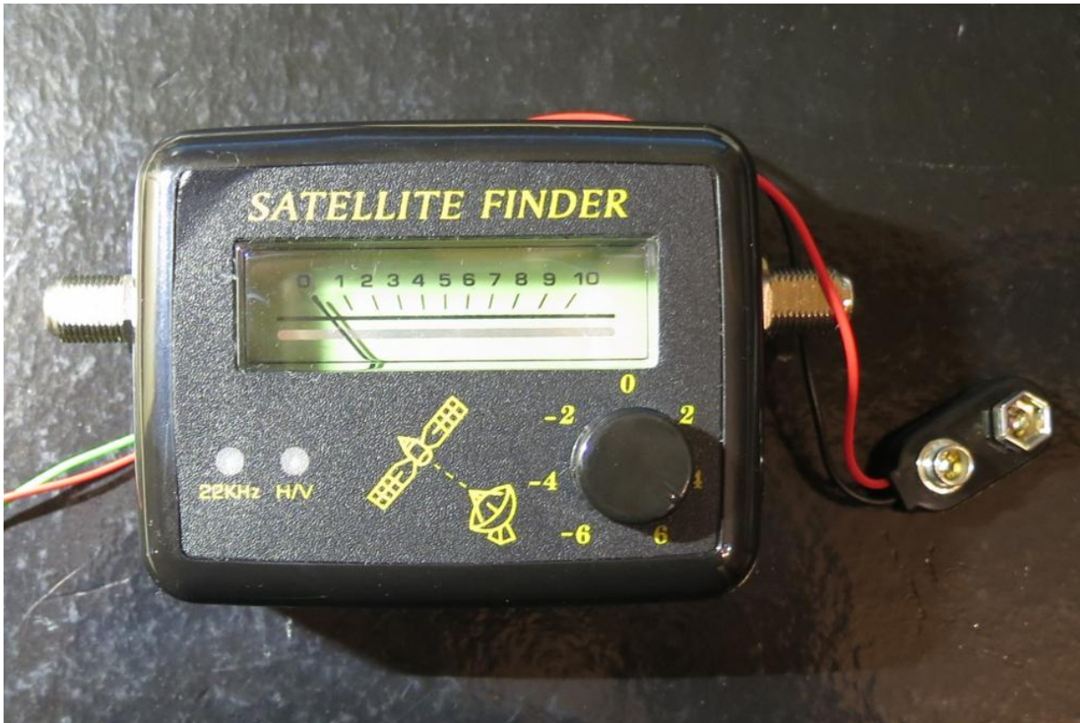
Fig. 1: SAT Finder, nach dem Umbau, man sieht links und rechts die F-Stecker Eingänge und den Batterieclip
