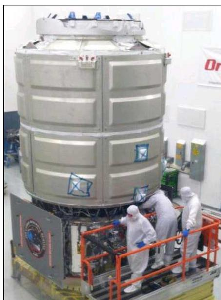
Die Cygnus-Attrappe wird für den ersten Testflug im April 2013 vorbereitet. Oben das unter Druck stehende Frachtmodul und unten das Servicemodul. Foto: OSC.
