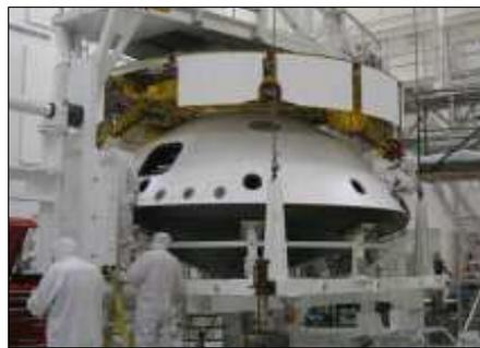
Das Raumschiff mit dem Mars Rover bei der Integration. Foto: NASA
