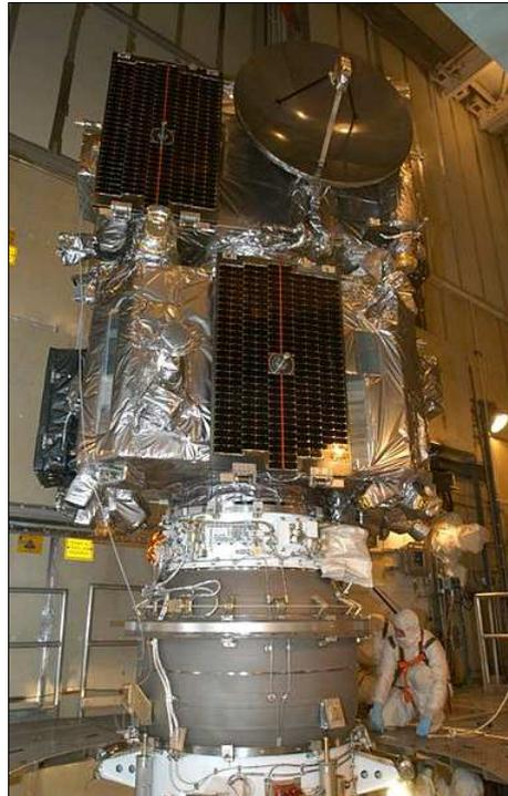
Die beiden Raumsonden auf der dritten Stufe der Delta-Rakete. Foto: NASA.
