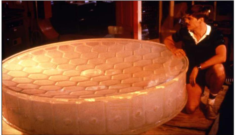
Der moderne Hauptspiegel des VATT (Vatican Advanced Technology Telescope) in Honigwaben-Bauweise mit einem Durchmesser von 1,8 Metern. Bild: Vatikanische Sternwarte.
