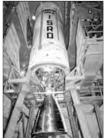
Die zweite GSLV-Stufe mit 2,8m Durchmesser und einer Ladung von 37,5 Tonnen flüssigen Treibstoffes (UDMH & N2O2).
