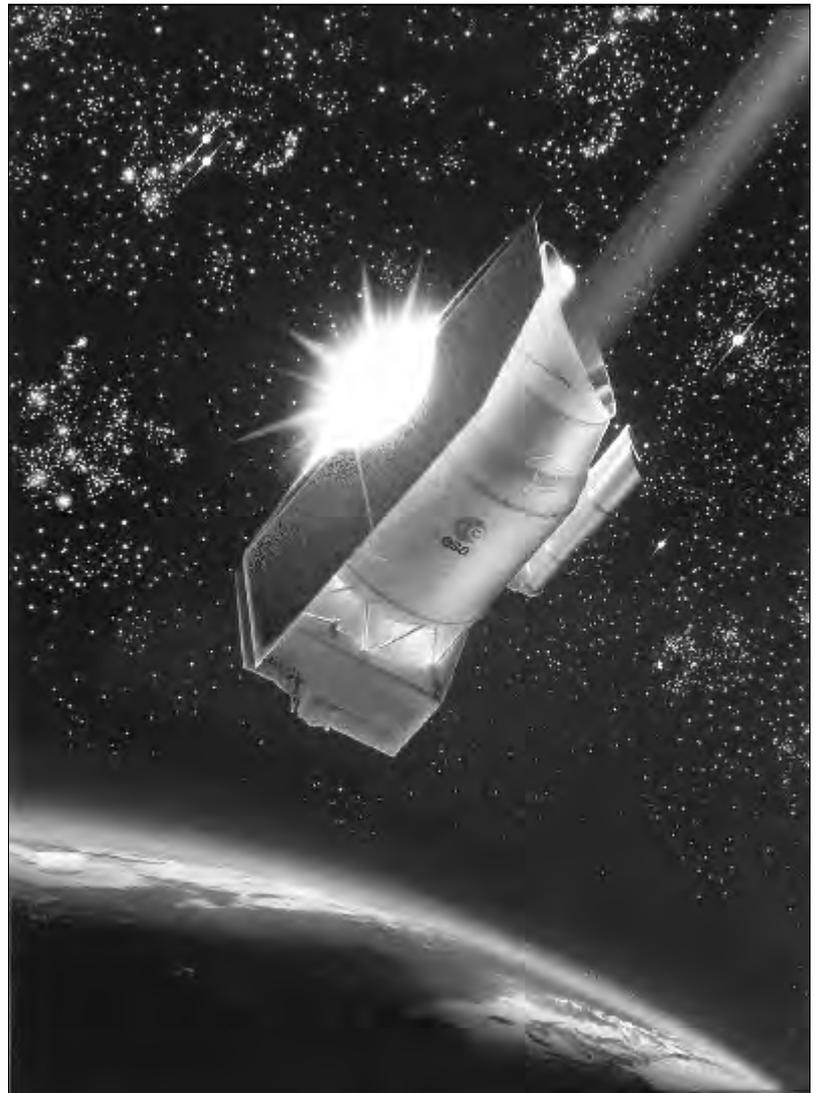
Der Infrarotsatellit ISO besteht aus einem Teleskop mit 60 cm Öffnung und aus vier separaten, einzeln vom Boden aus steuerbaren Instrumenten zur Analyse des einfallenden Infrarotlichtes. Große Teile des Satelliten wurden während der Mission (Dezember 1995 – Mai 1998) mit flüssigem Helium auf  $-270\text{ Grad Celsius}$  (3 Kelvin) gekühlt. (ESA)
