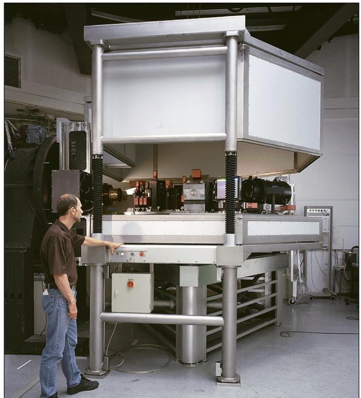
Das UVES-Instrument wird geschlossen, nachdem alle Komponenten installiert sind. Die Einhausung kann motorisch geöffnet werden, im normalen Betriebszustand gewährleistet sie eine lichtdichte und temperaturstabile Umgebung für die empfindlichen Teile. Foto: ESO.
